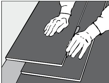
**7** Einpassen der letzten Dielenreihe: Legen Sie exakt auf die zuletzt verlegte Dielenreihe die nachzusägende Dielle. Dann zeichnen Sie mit Hilfe einer weiteren Dielle den Längsschnitt an. Durch diese Art des Anzeichnens bleibt genügend Abstand zur Wand, um die letzte Reihe mittels Zugeisen einzuwinkeln.
