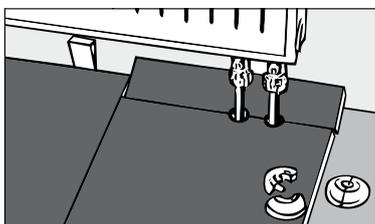
**5** Bei Heizungsrohrdurchbrüchen die Dielle am Stoß ausklinken und mit Heizkörperrosetten abdecken.
