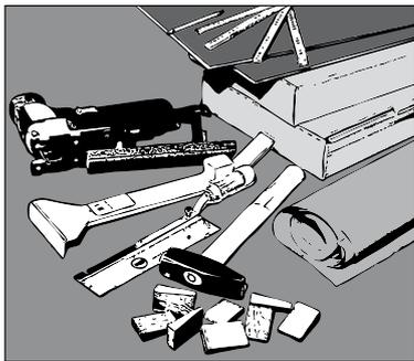
**1** Alles bereit? PE-Folie und Kleband. Als Werkzeug benötigen Sie: Zollstock, Bleistift, Stichsäge, Fuchsschwanz, Fäustel, Setzlatte, Zugeisen, ZIRO-Schlagklotz, Abstandskeile.
