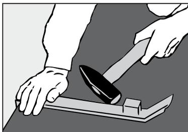
**8** Die letzte Dielenreihe wird mit dem Zugeisen längsseitig und mit dem ZIRO-Schlagklotz stirnseitig zusammengetrieben.
